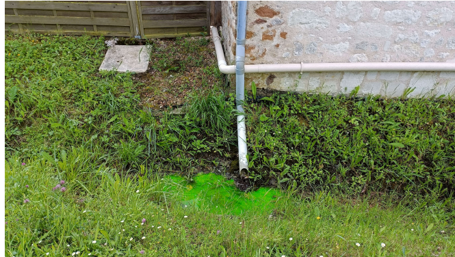
Photo 5: Test au traceur
